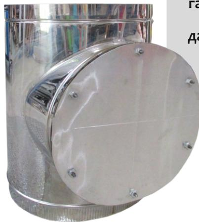
При возникновении нештатной ситуации в котельной, которая может привести к взрыву скопившегося газа, взрывной клапан спускает излишнее давление в дымоходе, предотвращая его повреждение.
