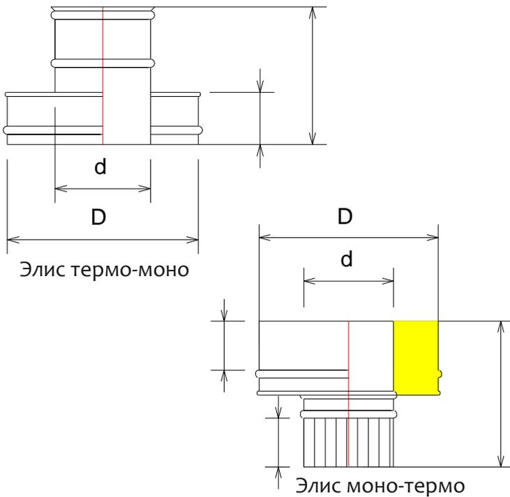
Элемент системы дымоудаления, предназначенный для соединения элементов системы различных диаметров, кроме того для перехода с неутепленного участка системы на утепленный.
